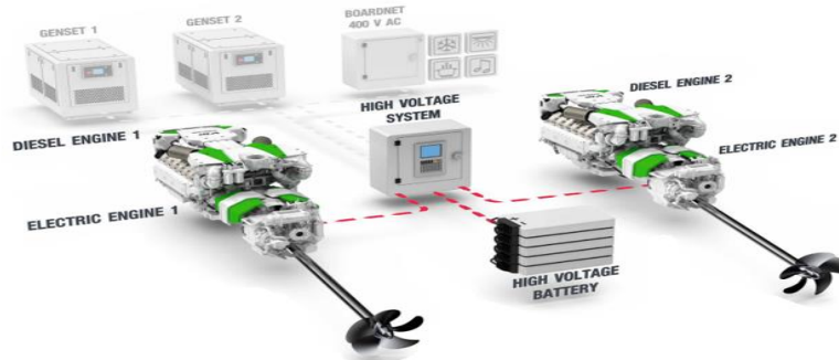
شكل (3): منظومة دفع وتوليد في سفينة ذات دفع هجين مع استخدام البطاريات.
