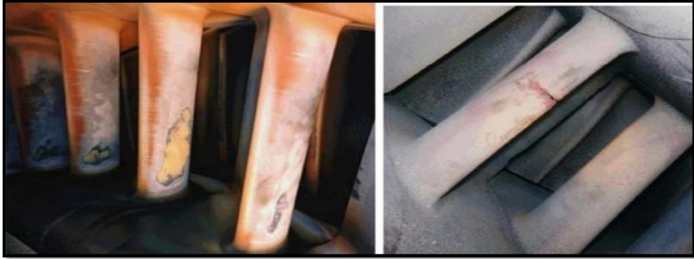
الشكل (4) التآكل في ريش التوربينة
